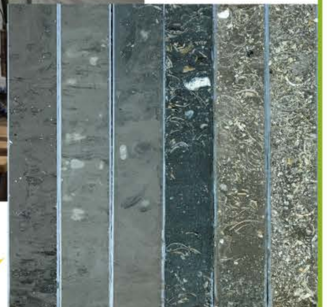
地下から採取されたボーリングコア
