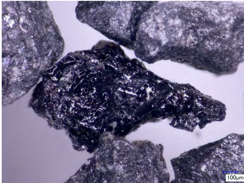
図3 塑性変形した黒色ガラス質粒子. 熔融・流動時の外形を保持している.
