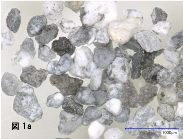
図 1a: 火山灰の 9 割以上を占める, 白色～灰色の変質岩片の光学顕微鏡写真(スケールバーは 1mm). 超音波洗浄器と純水による水洗, ふるい分け後, 手作業で集合させたもの.
