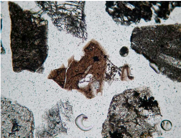
図2：構成粒子の薄片写真。上段の写真は視野の幅約2.5mm、下段の写真は視野幅約1.1mm。 下段はガラス質粒子。
