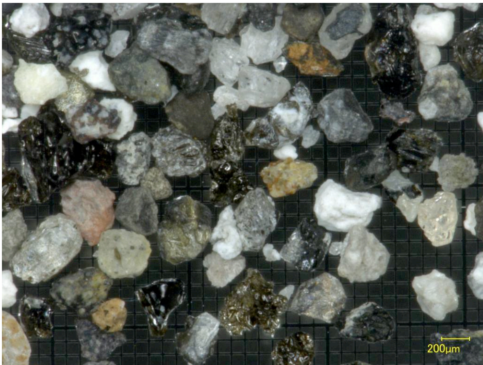
図2 0.5~0.25 mm に篩い分けされた粒子の検鏡写真 (2月17日産総研採取) (背景の1マスは0.1mm, 右下の黄色バーは0.2mm)
