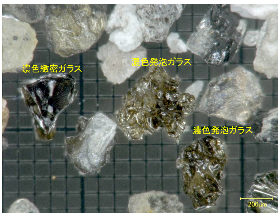
図4 2月17日採取火山灰に含まれる，実体顕微鏡下で新鮮に見える濃色ガラス質粒子 (背景の1マスは0.1mm，右下の黄色バーは0.2mm)
