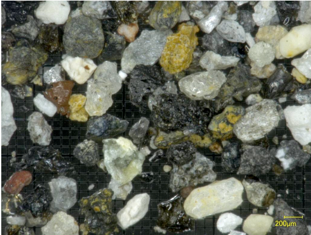
図1 0.5~0.25 mm に篩い分けされた粒子の検鏡写真 (2月12日気象庁採取) (背景の1マスは0.1mm, 右下の黄色バーは0.2mm)
