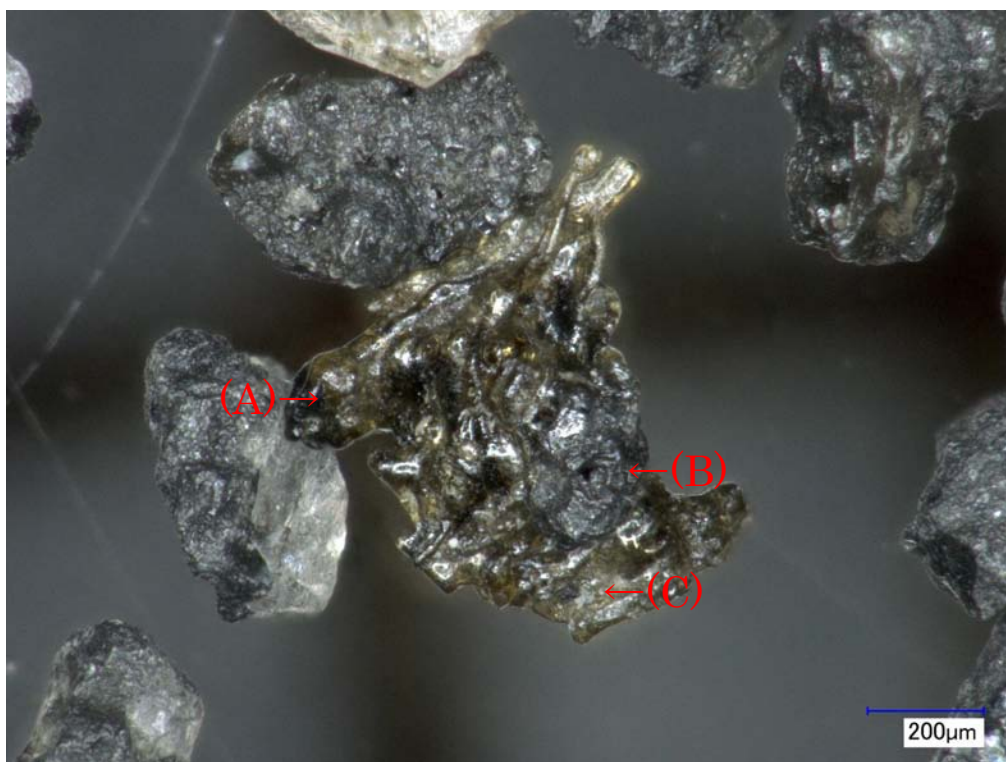
写真 1 試料 1126a の光学顕微鏡写真(写真 2 の拡大)。単一粒子内に「黒色不透明でガラス光沢(A)～(B)金属光沢」と「(C)淡褐色～褐色透明でガラス光沢」な部分が共存している。
