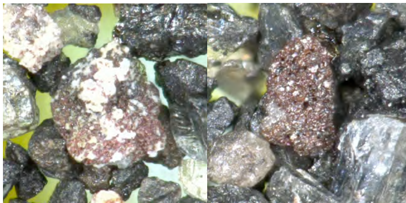
写真2b 試料2中の赤色を呈する変質岩片（左）と赤褐色の発泡ガラス片. 写真の横幅0.8mm.
