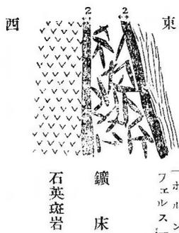
流スル一溪流アリ、竈場澤ト稱ス、海岸ヨリ該溪流ヲ溯ル約一里半ニシテ鐵鑛ノ露頭アリ、鑛床ハ石英斑岩ト「ホルンフェルス」トノ間ニ胚胎シ其走向北二十度西、傾斜東北東六十度ナリトス、其露頭ハ第十
