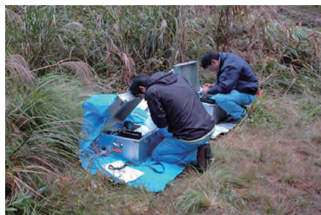
第7図 地磁気日変化観測装置。 ビニールシートで覆われたアルミ製トランク内にプロトン磁力計本体が収納されている。欠測を防ぐため2台設置して観測している。装置内部には、G-856AX プロトン磁力計本体、データ計測用 PDA / Tablet, バッテリー等が収納されている。 Fig.7 Daily magnetic variation observation system. Magnetometers were installed in aluminum cases covered by vinyl sheets. Two magnetometers were operated at the same time during the survey period to prevent data loss. Each aluminum case contains equipment such as a G-856AX proton magnetometer, a PDA/a Tablet and a battery.
