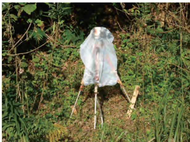
第6図 プロトン磁力計センサー。 雨水を避けるため半透明のビニール袋で覆われている。磁力計本体とは同軸ケーブルで接続される。 Fig.6 Sensor of a proton magnetometer to observe daily magnetic variations. The sensor is covered by translucent plastic sheet to avoid getting wet with rain. The sensor is connected to a G-856AX proton magnetometer by a coaxial cable.
