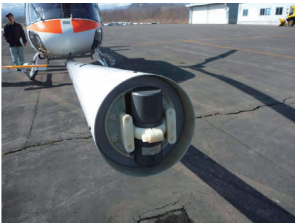
第3図 セシウム磁力計センサー（大熊・中塚，2013）。スティンガー先端部に設置されたセシウム磁力計センサー。写真のように円柱状センサーの長軸部を鉛直方向にして設置する。
