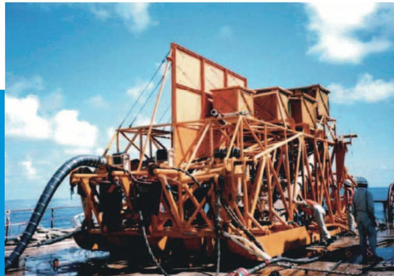
写真 大型プロジェクト「マンガン団塊採鉱システムの研究開発」の海洋実験用集鉱機
