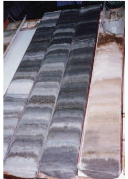
写真 海底から柱状に採取された堆積物試料（コア）珪藻の遺骸からなる縞模様の発達したフィリピン海の堆積物。
