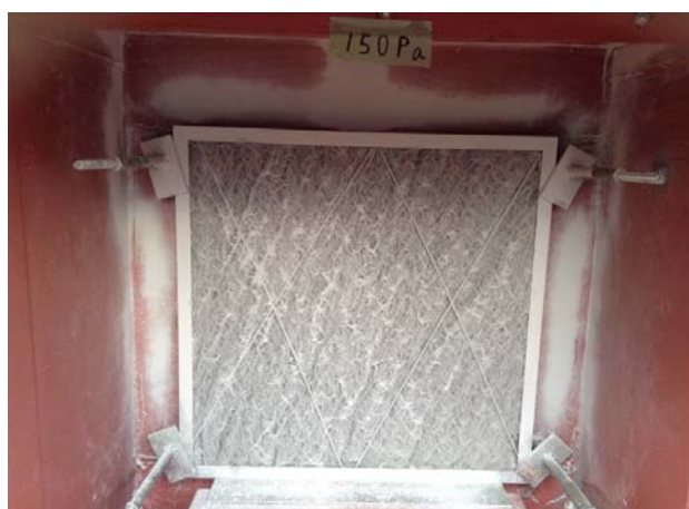
写真-67 圧力損失 150Pa
