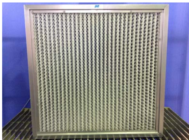
写真-54 試験前 フィルタ下流面
