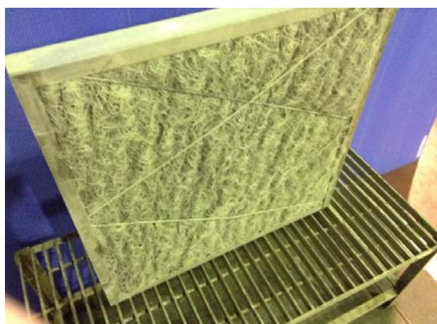
写真-11 試験後 フィルタ上流面
