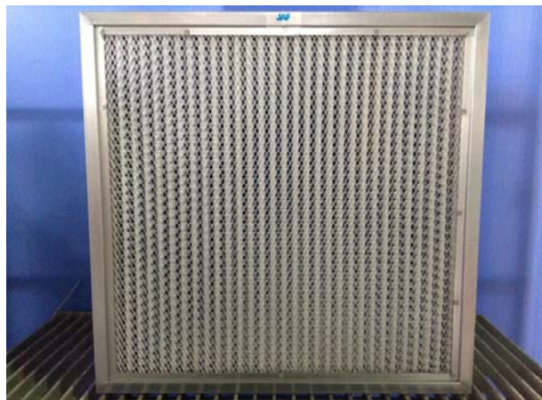
写真-58 試験前 フィルタ下流面
