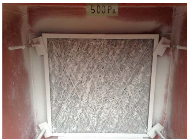
写真-72 圧力損失 500Pa
