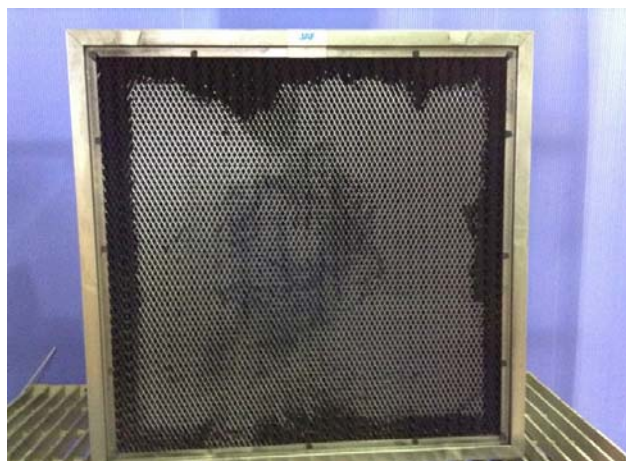
写真-51 試験後 フィルタ上流面
