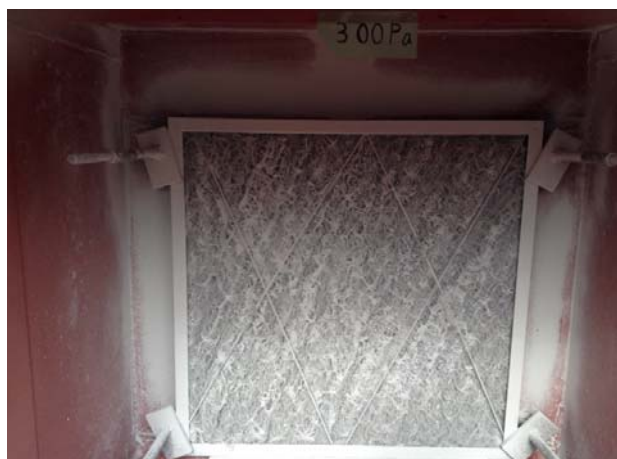
写真-70 圧力損失 300Pa
