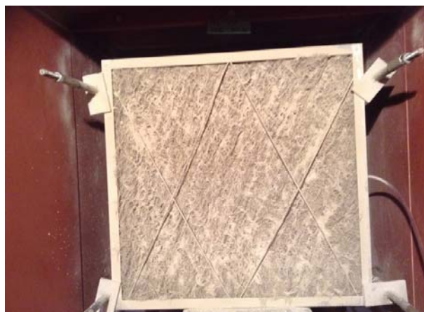
写真-79 圧力損失 450Pa
