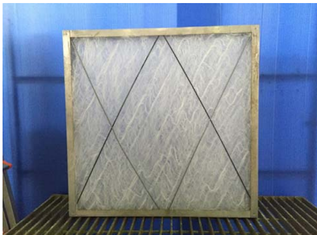
写真-33 試験前 プレフィルタ上流面
