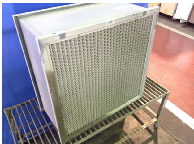
写真-15 試験後 フィルタ上流面
