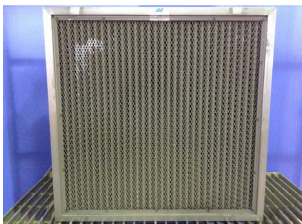
写真-55 試験後 フィルタ上流面
