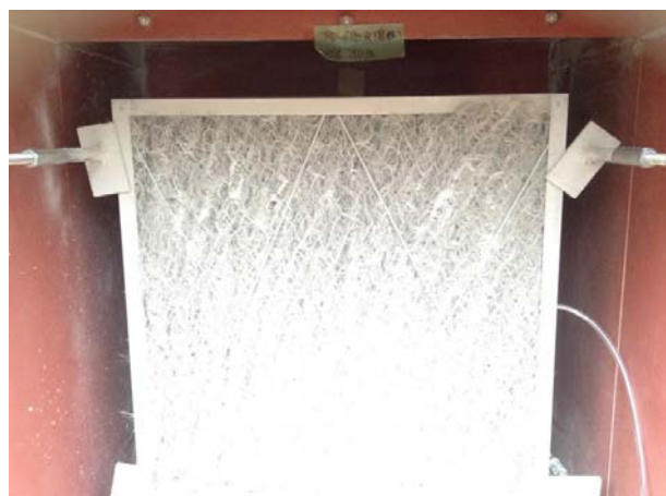
写真-74 圧力損失 140Pa
