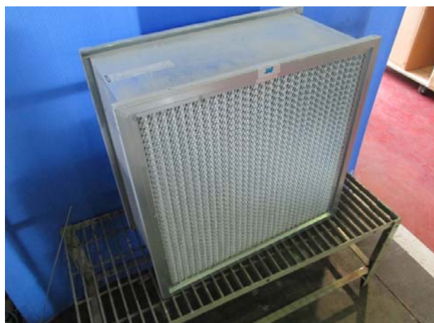
写真-20 試験後 フィルタ下流面
