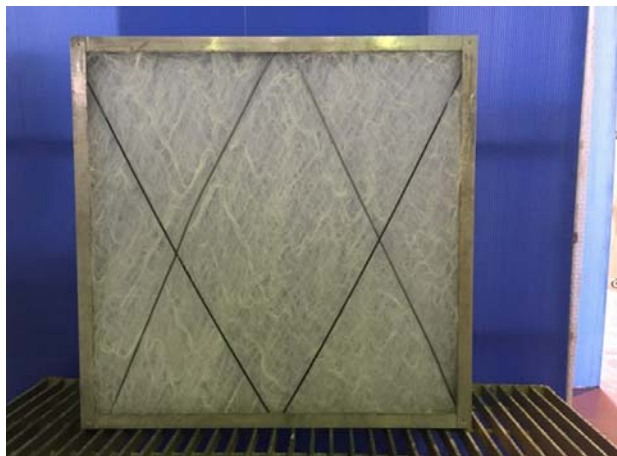
写真-25 試験前 プレフィルタ上流面
