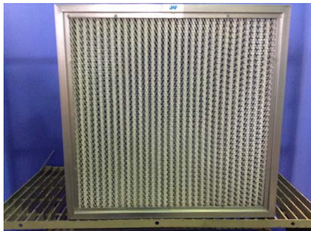
写真-50 試験前 フィルタ下流面
