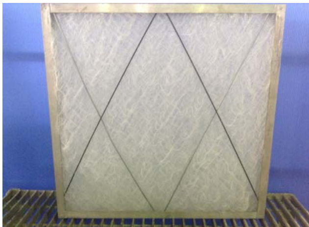
写真-1 試験前 フィルタ上流面
