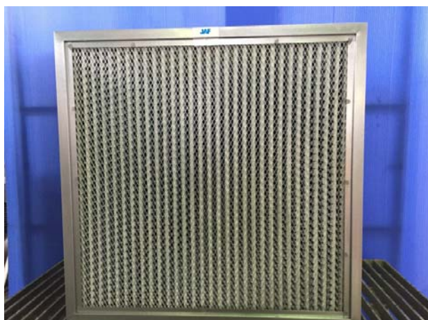
写真-40 試験後 中性能フィルタ下流面
