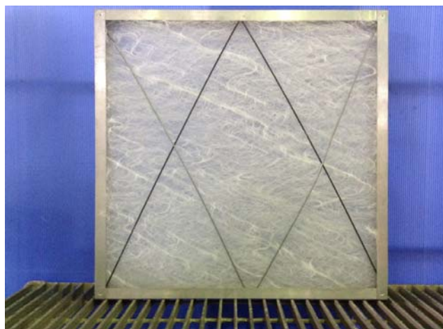
写真-5 試験前 フィルタ上流面
