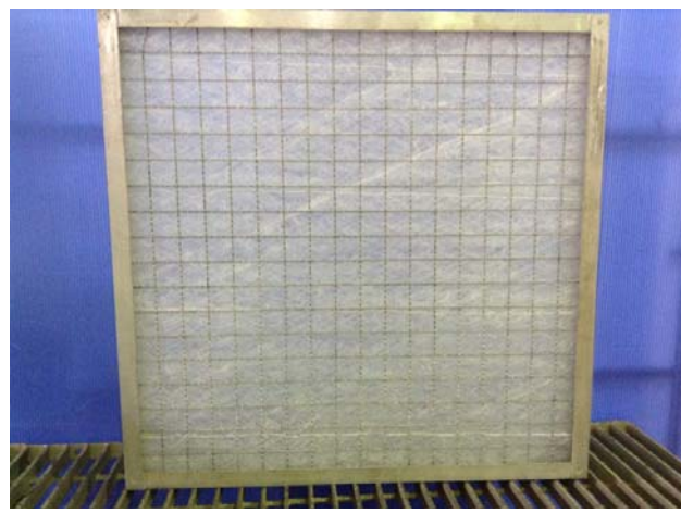
写真-6 試験前 フィルタ下流面
