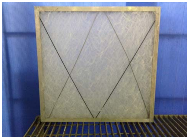
写真-41 試験前 プレフィルタ上流面
