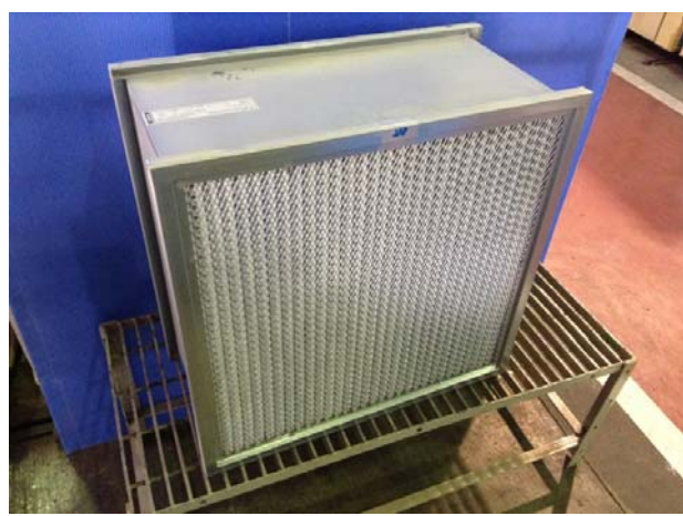
写真-16 試験後 フィルタ下流面
