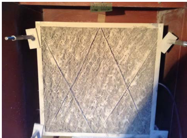
写真-77 圧力損失 335Pa
