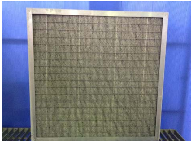
写真-46 試験後 プレフィルタ下流面
