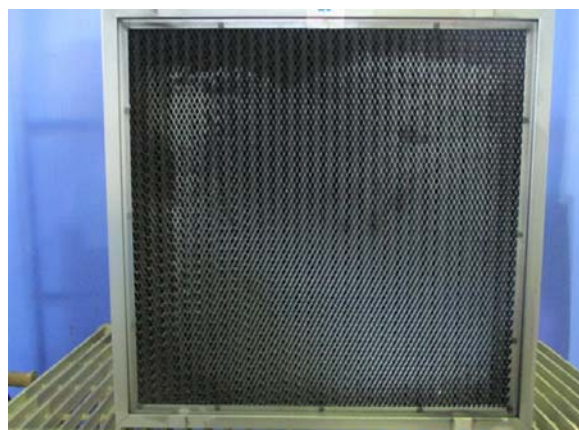
写真-63 試験後 フィルタ上流面
