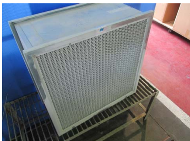
写真-19 試験後 フィルタ上流面
