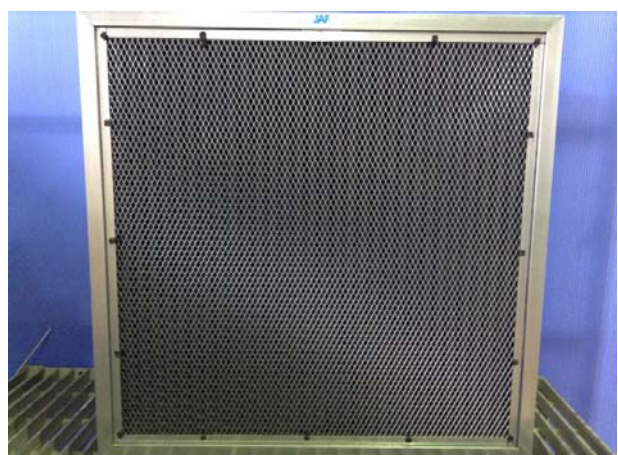
写真-59 試験後 フィルタ上流面
