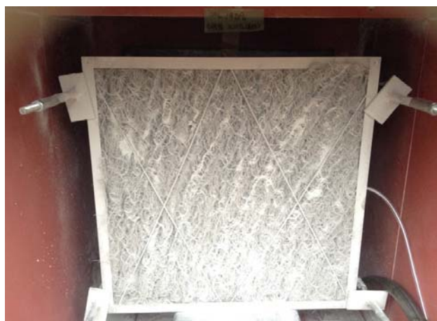
写真-75 圧力損失 190Pa
