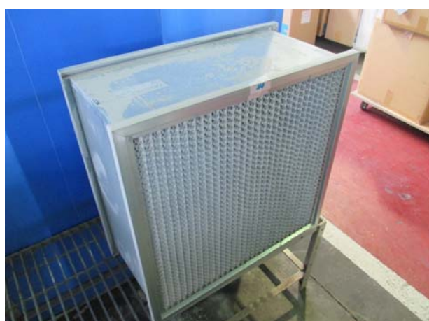
写真-24 試験後 フィルタ下流面
