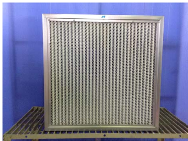
写真-62 試験前 フィルタ下流面
