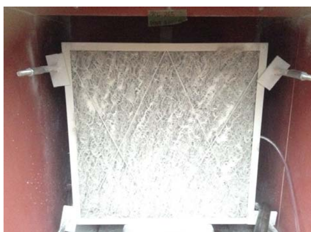
写真-76 圧力損失 265Pa
