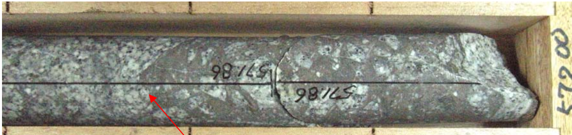
t) 孔1 571.7-572m 花崗閃緑岩と煌斑岩の境界: くの字の面あり 煌斑岩は花崗閃緑岩を礫状に多く取り込む。
