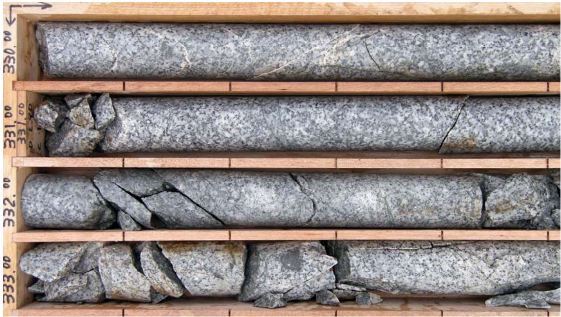
d) 孔 1 花崗閃緑岩の岩相 330m 付近 緑色脈，沸石細脈が潜在割れ目となっている。
