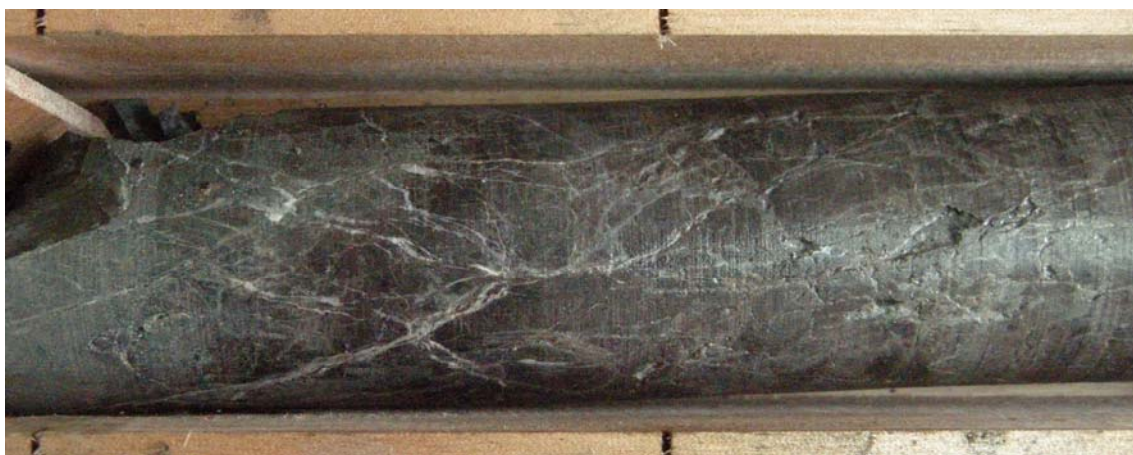
q) 孔1 552.40m 付近 ホルンフェルス 白色脈ネットワーク発達, 潜在割れ目多い
