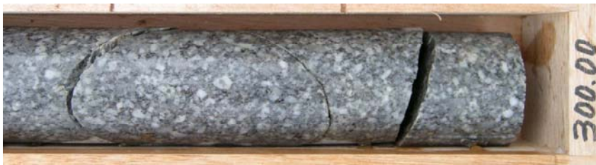
b) 孔1 花崗閃緑岩の岩相 299.85m 長石が斑晶状に見える。
