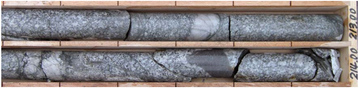
a) 孔 1 213m 付近 花崗閃緑岩中の石英脈，捕獲岩
