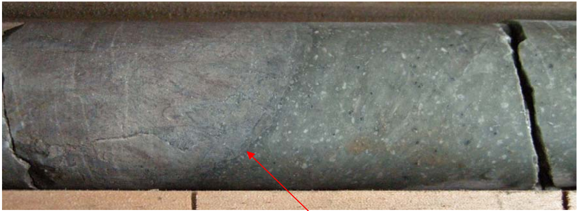
r) 孔1 551.80m ホルンフェルス(左側)/流紋岩(右側)貫入面 (密着)
