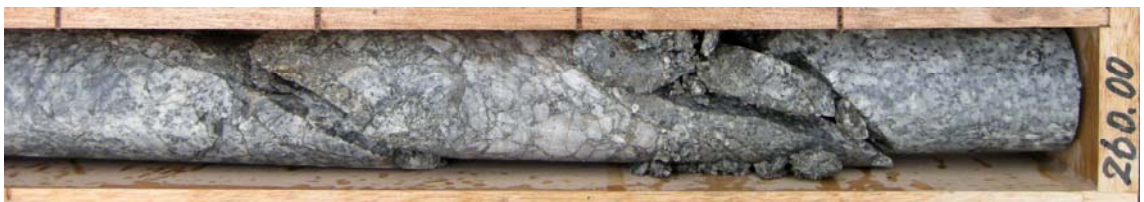
e) 孔 1 259.70~259.90m 傾斜 60~70° の断層破碎帯
