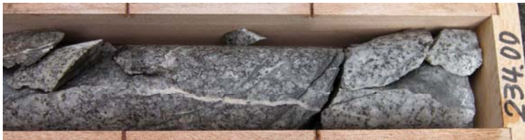
c) 孔 1 233.85m 付近 高角度の沸石細脈（黒色～緑色脈を切る）
