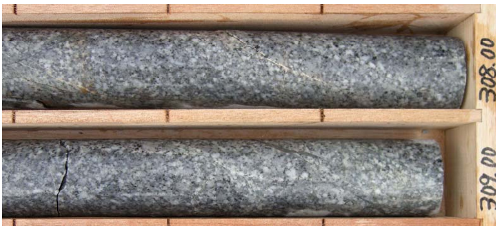
c) 孔1 花崗閃緑岩の岩相 308m 付近 沸石細脈沿いの変質
