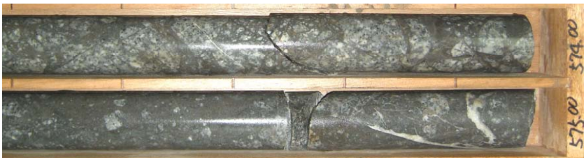
u) 孔1 573.5~575.00m 煌斑岩岩相 黒雲母に富む火成岩、花崗閃緑岩礫を多く含む。
