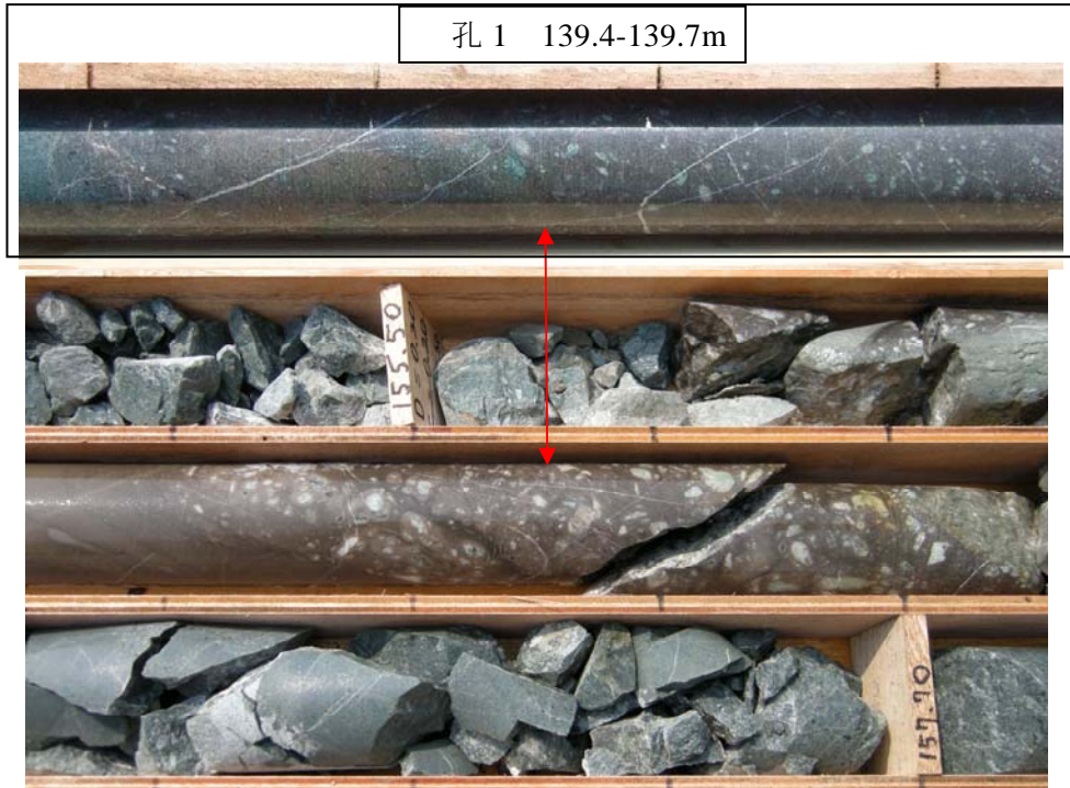
a) 孔 2 156.4～156.7m の凝灰岩と孔 1 139.4～139.7m の凝灰岩を対比した
