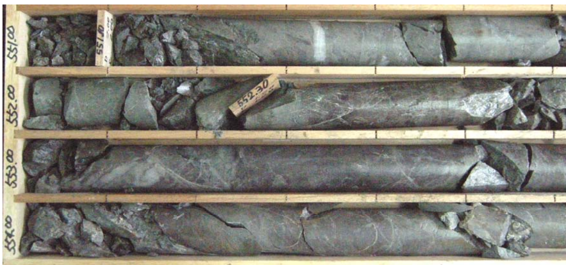
p) 孔1 ホルンフェルス 551.00～551.25m 間, 554.00～554.20m 間は角礫状コア 伴う破碎部。柱状コア部も潜在割れ目多く脆い。
