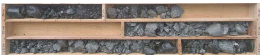
c) 孔3 20～23m 破碎帯 角礫状に破碎されており、コアロス部も生じている。
