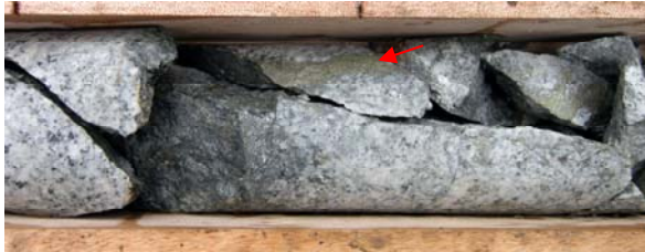
g) 孔 1 花崗閃緑岩 324.60m 付近 黄鉄鉱染
