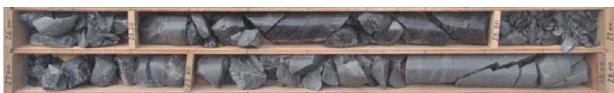
d) 孔3 26～28m 砂岩優勢砂泥互層 割れ目多い岩盤
