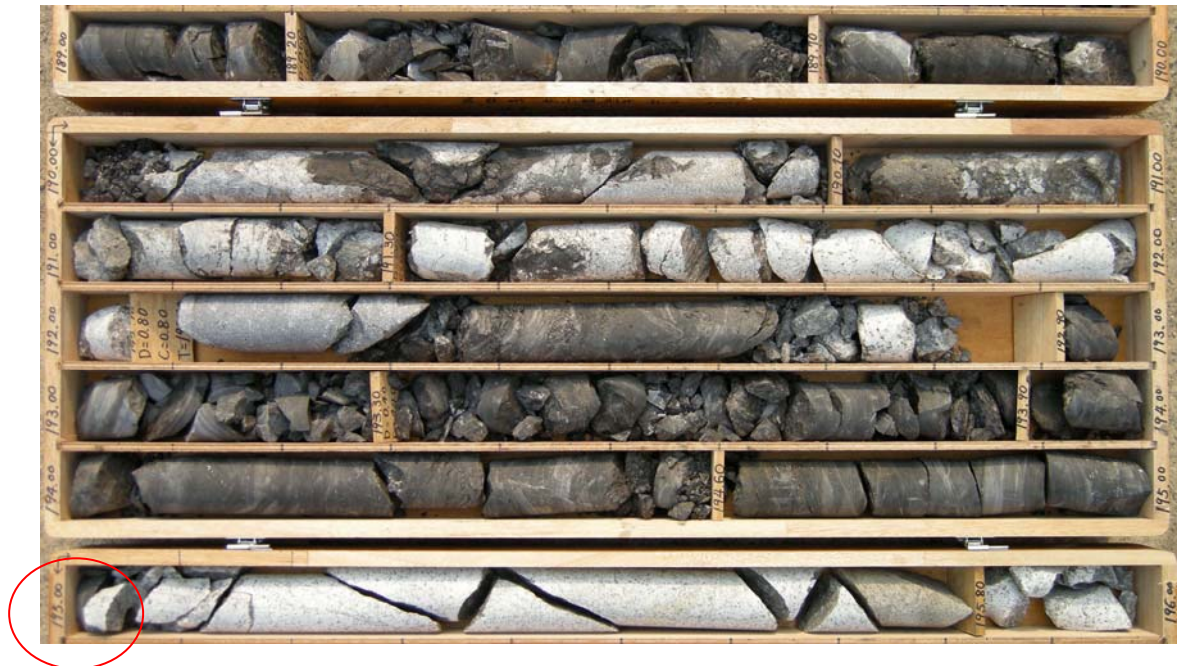
c) 孔 2 189-196m 和泉層群礫岩～泥岩～不整合(赤丸内)～花崗閃緑岩 和泉層群の岩石は破碎を受けクラッキーな部分が多い。
