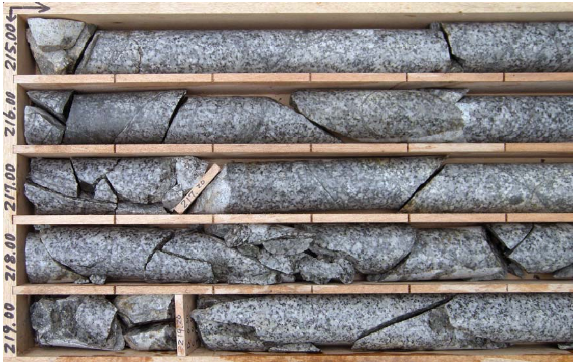
a) 孔1 花崗閃緑岩の岩相 215～219.5m 柱状コア～片状コア、潜在割れ目入る
