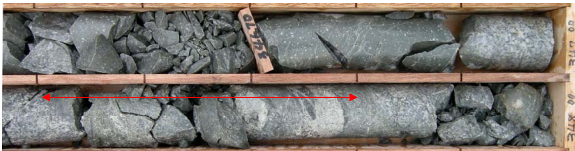
k) 孔 1 流紋岩中の破碎帯 347.50~347.80m 間, 傾斜 \angle 50^\circ , 砂状~角礫状
