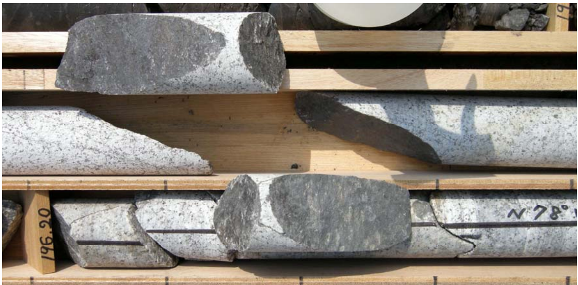
d) 孔 2 196.30～196.50m 花崗岩の割れ目（節理）に泥質物入り込む。 割れ目に黄鉄鉱付着している。
