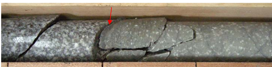
m) 孔 1 510.60m 花崗閃緑岩/流紋岩 貫入 流紋岩に急冷相認められる
