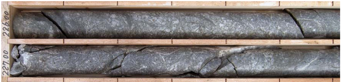
b) 孔 1 226~227m 付近 花崗閃緑岩中の圧砕岩
