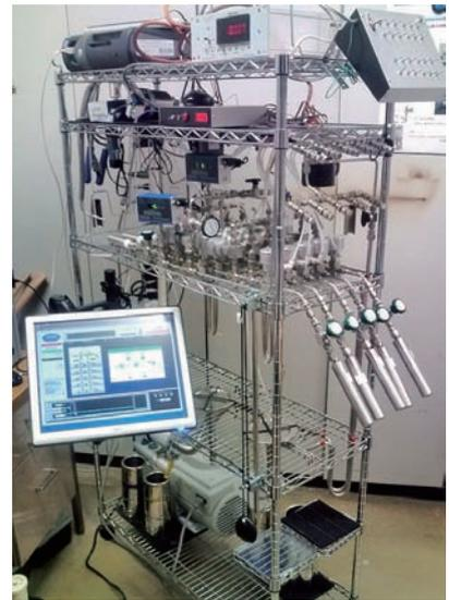
写真 小型汎用ガス精製システム。
