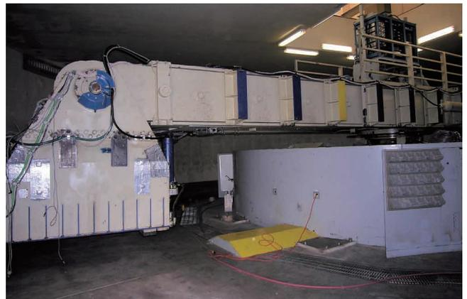
写真2 U.C.Davisにあるcentrifuge。直径が9mあり、75Gの遠心加速度を発生できる。
