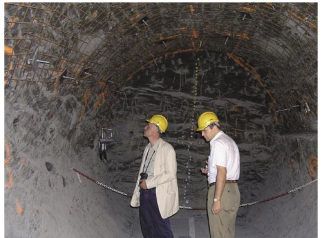
写真2 Mont Terri 地層処分研究施設の見学風景。トンネル掘削による地盤変形実験現場。
