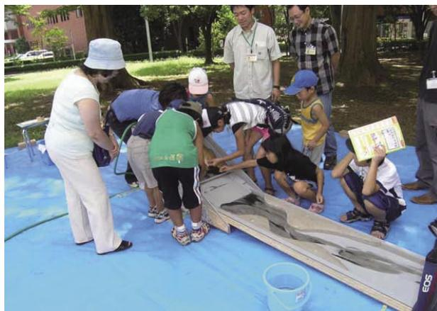
写真：「山から川へ」の水路実験装置での実演の様子。川の源流から岩石の風化、土砂の侵食・運搬、下流部での堆積といった一連の碎屑物の粒子の動きが見えるように工夫されている。
