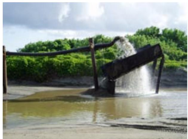
写真1. 現在の川底からポンプで採取されている砂。
