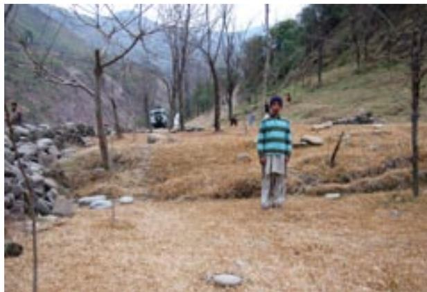
写真2. Jhelum川左岸で確認された地震断層。人物のすぐ後ろに1mほどの小崖として見えているが、撓曲状の変形も含めると上下変位は約2mに達する。
