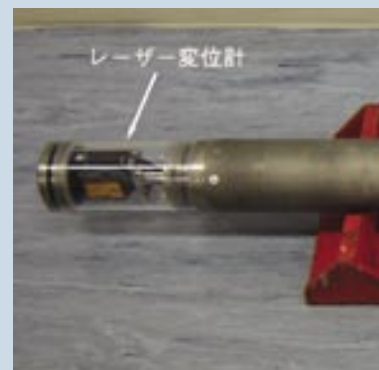
写真 2 装置の心臓部。レーザー変位計を 360 度回転させて孔径を測定します。
