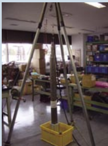
写真 1 応力方位測定装置の室内でのテスト風景。三叉でつり下げられています。対応孔径は 116mm です。
