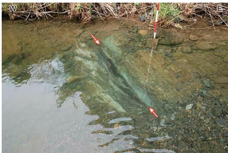
第 12 図 天ノ川河床にみられる御齋所変成岩（東側）と堆積岩（西側）の境界をなす井戸沢断層（矢印で示す）．第 11 図の擁壁の破壊箇所の延長部河床に位置する．北に向かって撮影．2012 年 5 月 19 日撮影．
