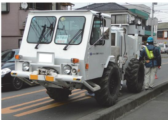
第2図 本調査の発震作業に用いた震源車（パイブロサイス）
