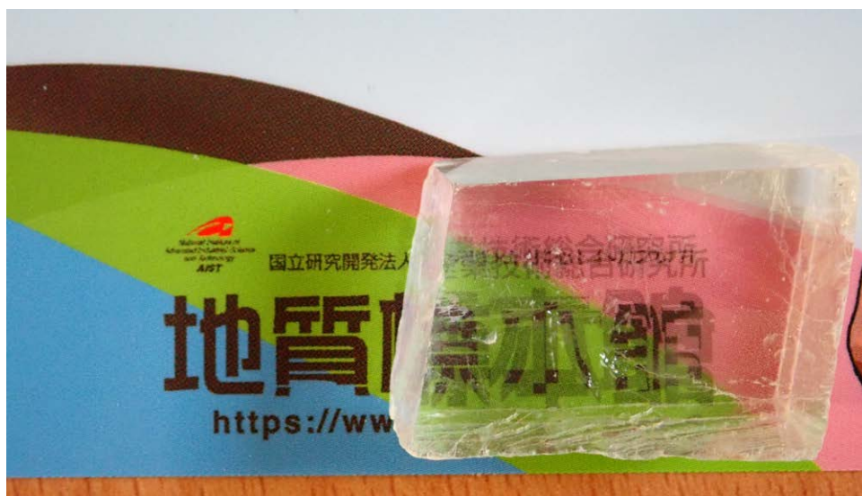
第8図 方解石の複屈折. 方解石の下の字が二重に見える。
