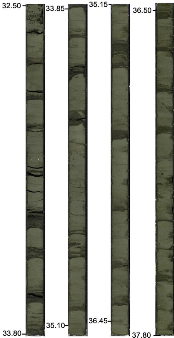
第4図 採取されたコアの例 (JAMSTEC による)。黒色部がタービダイト。左側の数字は海底からの深度 (m) を示す。プレスリリース 資料 ( https://www.aist.go.jp/aist_j/press_release/pr2020/pr20200129/pr20200129.html あるいは http://www.jamstec.go.jp/j/about/press_release/20200129 , 閲覧日: 2020年3月16日) から転載。
