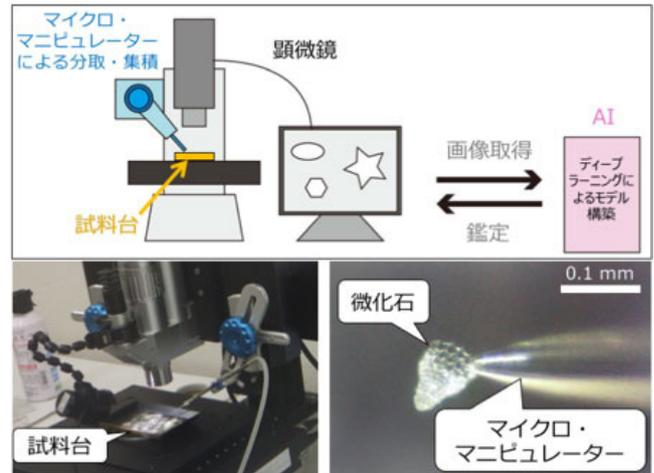
第3図 今回開発したシステムの全体像。下左写真：試料台に微化石を散布し、マニピュレーターで分取する様子。下右写真：マニピュレーター先端部の拡大。
