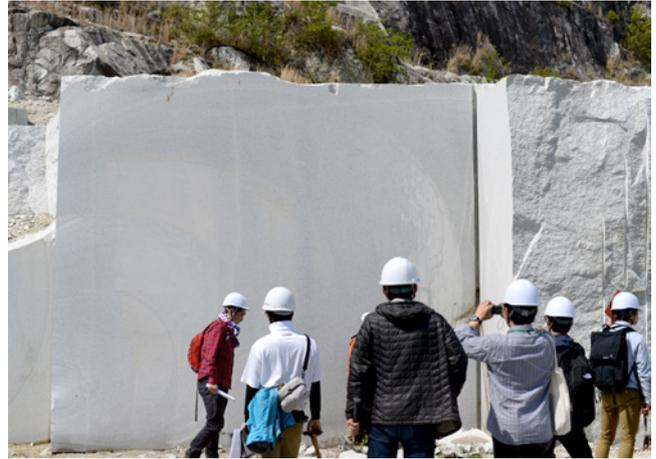
写真2 稲田石採石現場(株式会社想石)。ワイヤーソーによる採石のため、表面が平らで美しく観察しやすい。
