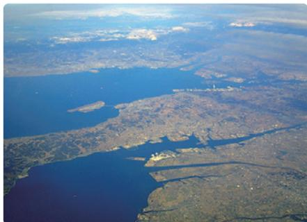
知多半島の中軸部はなだらかな丘陵からなり、臨海部には台地や沖積低地が分布する。丘陵は粘土層と砂層の互層からなる鮮新・更新統常滑層群からなり、そこから産出する粘土層は地元の陶磁器「常滑焼」の原料となっている。2005年2月に開港した中部国際空港は、常滑市沖合の1.5 kmの伊勢湾海上に人工島を造成して建設された。その水深は6~7 m程と浅く、盛り土の直下が基盤の東海層群となっている。
