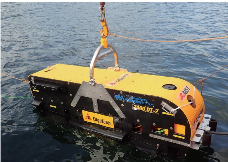
第2図 深海曳航式精密海底調査機器の海域での運用の様子。サイドスキャンソナーとサブボトムプロファイラー、インターフェロメトリックのスワース測深装置、動揺センサー等を装備している。海中で曳航することにより、調査船に比べて格段に詳細な精度の海底表面の情報、海底表層部の地層情報、海底地形情報を得ることが可能である。
