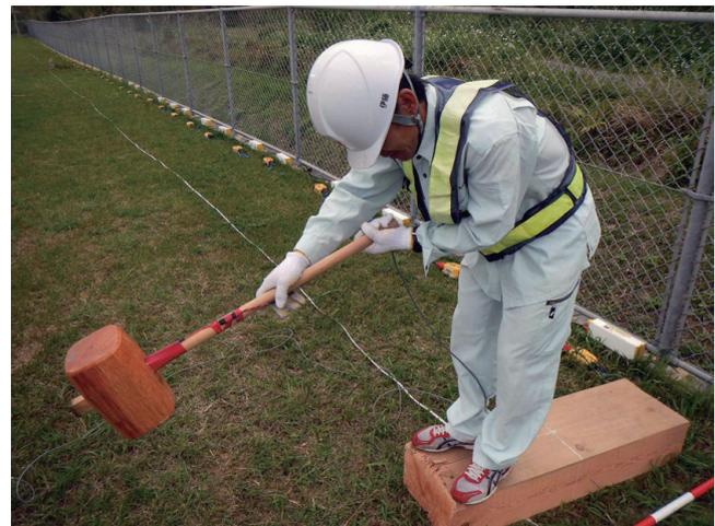
写真1 掛矢を用いた板叩きによるS波発震作業の様子。この探査では2人が板にのって荷重を加えて発震したが、撮影のためにこの写真では1人しかのっていない。
