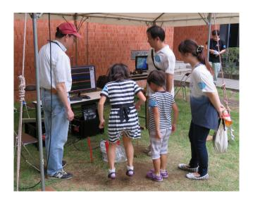
第4図 地震計の前で飛び跳ねたときの震度を測る実験の様子. ビニール袋に包まれた地震計で計測された地震波形と震度がモニタに表示されるようになっています.
