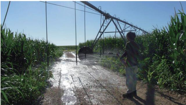
第6図 トウモロコシ畑を稼働中の灌漑システム、センターピボット式スプリンクラーシステム。
