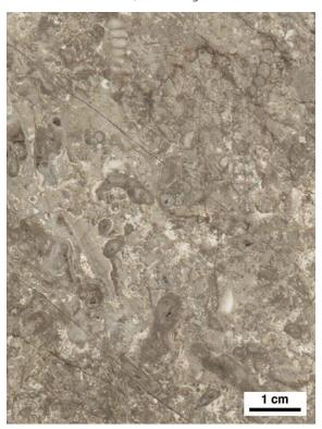
第7図 海綿類を含む石灰岩.中期ペルム紀には小球状の石灰海 綿類が造礁生物として繁栄した.石灰海綿類は暖かい海 に棲む典型的な従属栄養生物であり,それらの繁栄は当 時の富栄養化した温暖な海洋環境を推定させる.
