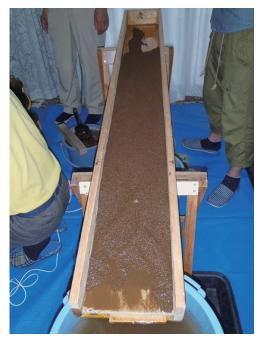
第2図 池田先生が手作りされた3D実験水路および再現された網状河川地形. 材料はホームセンターで購入できるものばかりである. 給水にはお風呂の排水用の小型水中ポンプを使用し、変圧器を使って流速をコントロールしている. 網状河川地形を水路実験で復元することは大変難しく、この実験に用いた土砂は園芸用の鹿沼軽石と記憶している.
