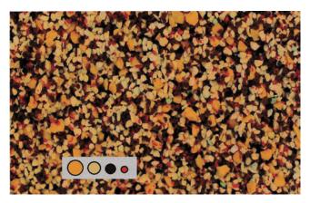
第6図 モデル粒子の接写写真. 粒子径は 0.7~2 mm, 粗粒~極 粗粒砂のサイズである. 大きさ毎に色が異なる点がアイデ アと言える. また, 実験に使用する粒子はプラスティック 製であり, 自然界の砂粒子より軽量で角張っているのが特 徴と言える. © 2012 Little River Research & Design.
