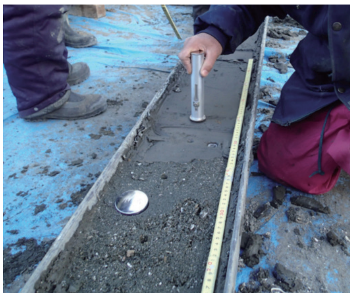
第 8 図 採取したての試料を用いた山中式土壌硬度計による地層の硬さ測定。
