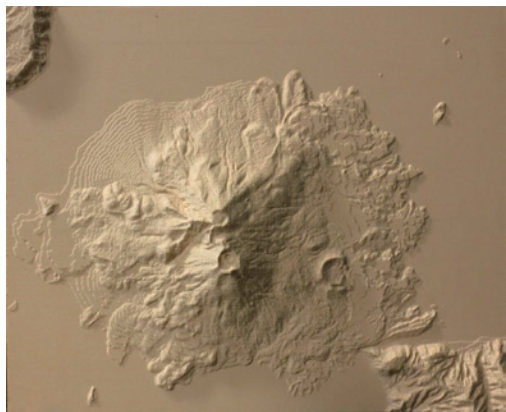
第1図 プロジェクションマッピングに用いた地形模型（投影前）. (X)29.50 cm × (Y)24.02 cm × (Z)2.91 cm. Z方向強調倍率 1.30倍. 縮尺 1/50,000 で作成.
