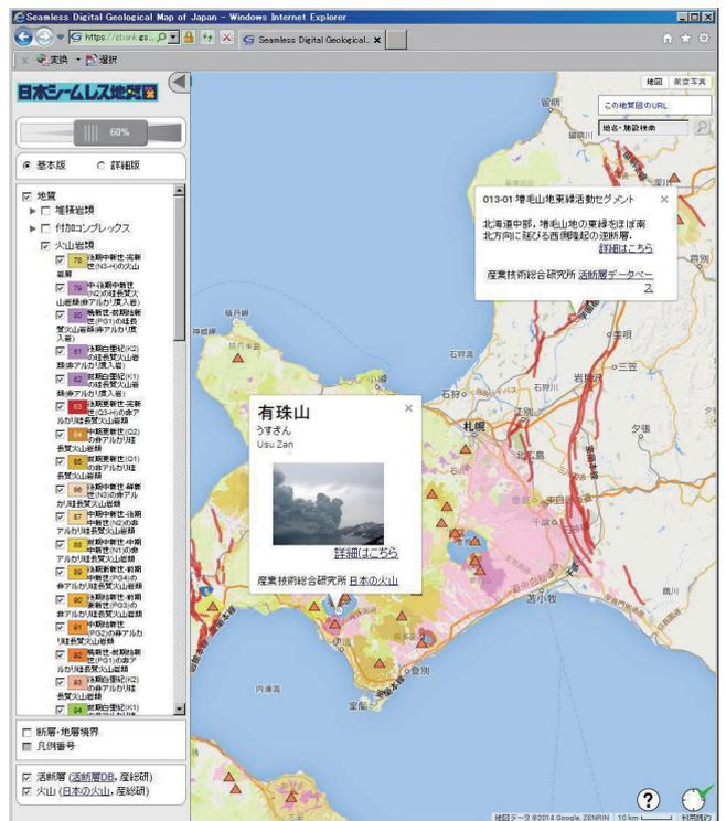
第5図 火山岩類のみを表示させた例。太いラインは活断層データベースに収録された活断層。ラインをクリックすると情報が表示される。火山データベースも△印をクリックすると情報が表示される。
