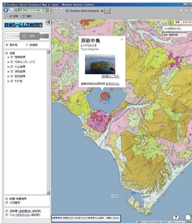
第4図 有珠山周辺を拡大し、凡例を表示させたもの。△印は日本の火山データベースとリンクしている火山。矢印にカーソルを置くと下の四角で囲んだ凡例の解説と標高値が表示される。あるいは、カーソルを置いたところをクリックすれば、ポップアップで表示することもできる。
