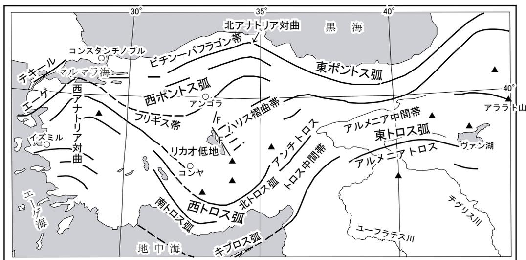
第4図 トルコ・アナトリア地方の基本走向線図。Naumann(1896)の図版1「アナトリアの基本走向線図」(原図は多色刷り、横幅約50cm)を大幅に簡略化し、和訳した。太線は一般走向線を、細線(F)は断層を、黒三角は火山を、それぞれ示す。この地方には北にポントス弧、南にトロス弧があり、並走するこれらの弧が南に向かって大きく張り出している。
