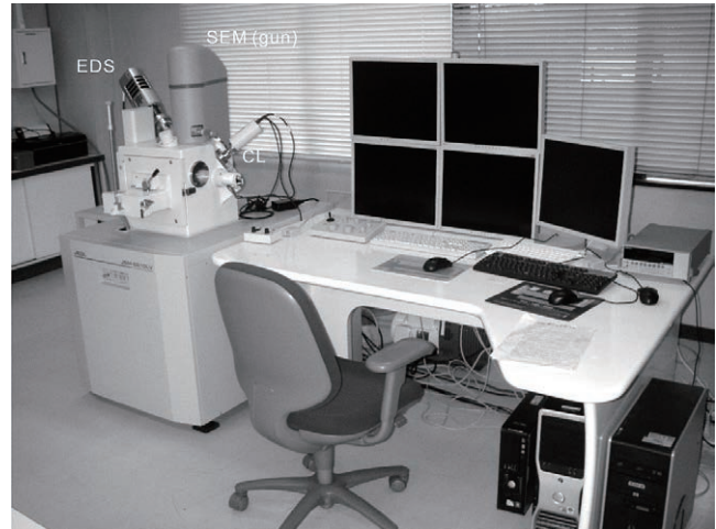
第3図 7-1棟153号室に設置された走査型電子顕微鏡。中央に電子銃(SEM gun)があり、その左面にエネルギー分散型エックス線解析装置の検出器(EDS)が搭載されている。装置本体右面にはカソードルミネッセンス検出器(CL)が装備されている。
