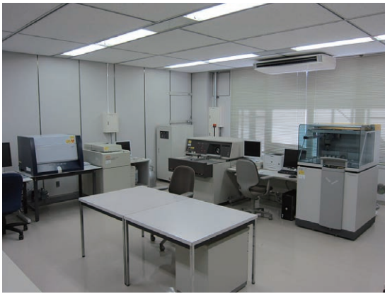
写真7 蛍光X線分析装置(XRF) [156室]. 全岩化学分析に使用される新旧2台の波長分散型蛍光X線分析装置(Philips PW1404とPANalytical Axios), エネルギー分散型XRF(JEOL JSX-3201), XRFマッピング装置(Bruker M4 Tornado)が設置されている。
