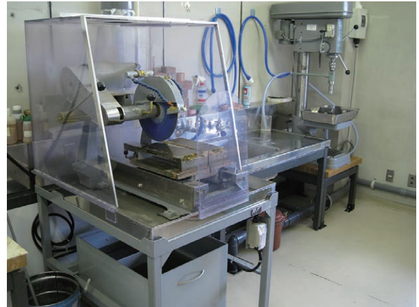
写真1 岩石カッター室設置の岩石カッターおよび円筒整形機。
