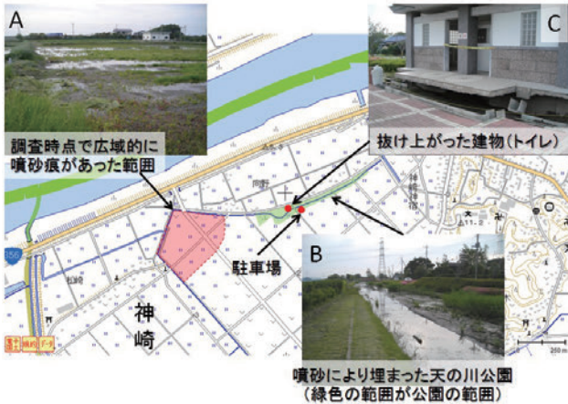
第3図 千葉県神崎町周辺の液状化被害の状況 (小荒井ほか, 2011). 背景は電子国土 Web システムを使用.
