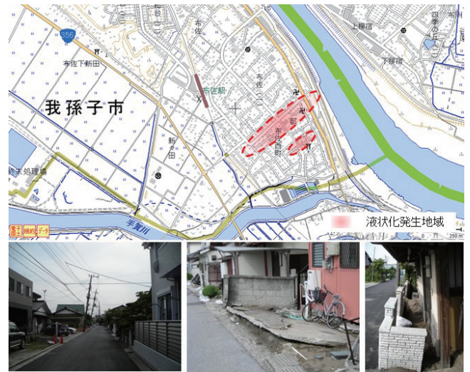
第6図 我孫子市布佐地区の液状化被害の状況 (小荒井ほか, 2011). 背景は電子国土 Web システムを使用.
