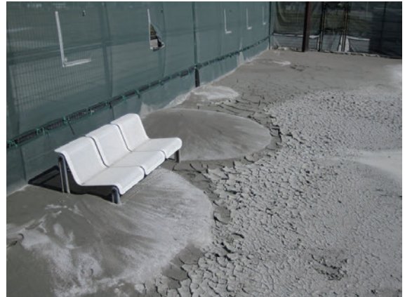
第 1 図 噴砂土堆積状況（明海大学テニスコート）。
