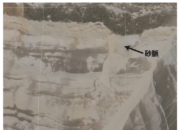
浚渫された砂層は液状化により全体的に堆積構造が乱されている。砂層中に砂脈（矢印）が観察され、上面でシート状に広がっている（東側壁面）。
