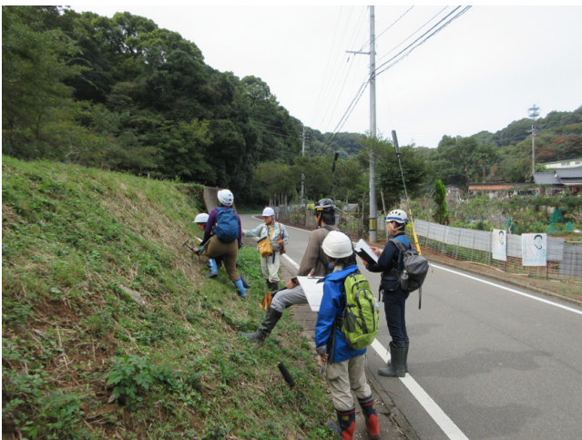
第10図 能古砂礫層の調査の様子。能古島の渡船場から北部（アイランドパーク）に行くバス路線沿いを踏査し、道路脇の法面に露出する能古砂礫層を観察する。能古砂礫層は、アルコース質の砂層で、未固結の地層である。ここでは、下草が刈られたところで地層が露出している。研修6日目に、能古小・中学校の北西の道路沿いで撮影。
