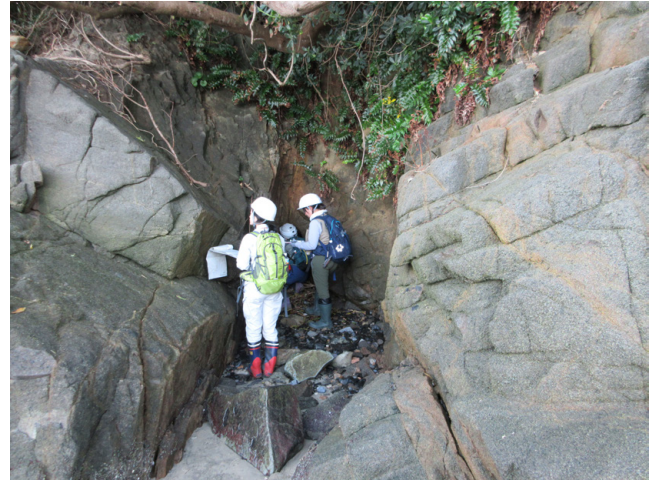
第 7 図 トーナル岩露頭の中に見られる断層の観察の様子。北崎トーナル岩の露頭の調査で見つけた断層の観察をして、断層面の走向傾斜や破碎帯の幅などを測定しているところ。研修 4 日目、能古島東岸の土手崎の北方で撮影。
