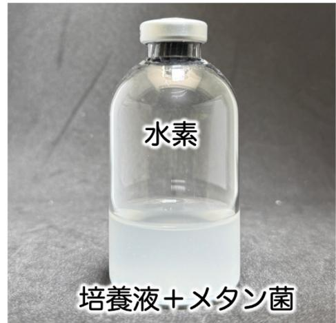
第2図 メタン菌を含む嫌気微生物の一般的な培養法。
