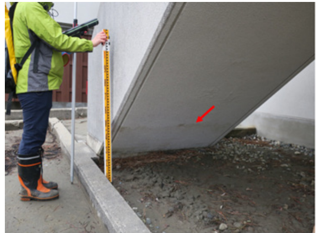
第3図 津波の浸水状況調査。建物壁面のウォーターマークを赤矢印で示す(地質調査総合センター公式ウェブサイトより)。
