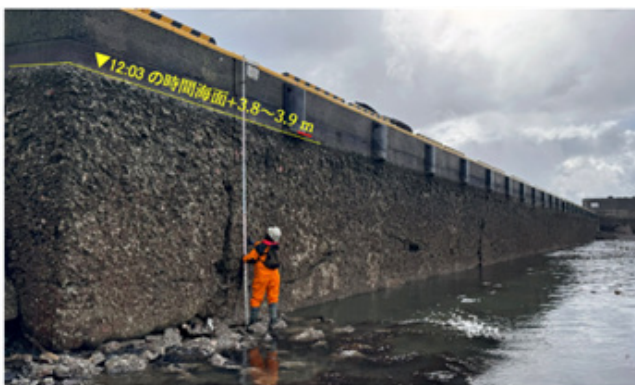
第2図 海岸の隆起調査。鹿磯漁港の防潮堤に固着した生物遺骸が示す隆起の様子。人が持っている標尺の長さは5m(地質調査総合センター公式ウェブサイトより)。
