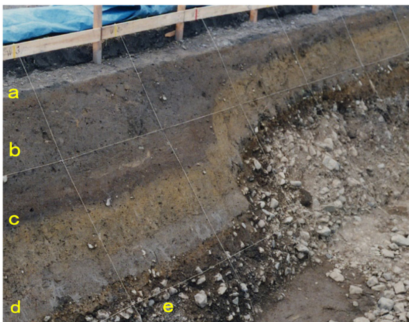
写真4 有馬-高槻断層帯・真上断層のトレンチ調査(筆者撮影) 弥生～室町時代の地層の変位量が同じ、それを江戸時代の耕作土(a)が覆う。(b:変位後の下盤側の盛土, c:鎌倉-室町時代の耕作土, d:奈良-平安時代の耕作土, e:弥生時代の砂礫)写真の右が北。
