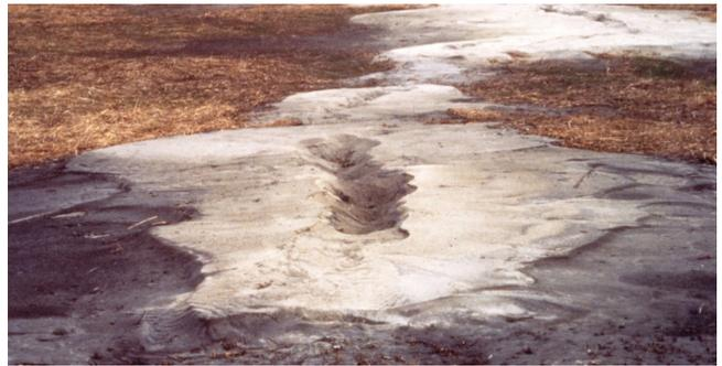
写真3 兵庫県南部地震で流れ出した噴砂(西宮市内で筆者撮影)
