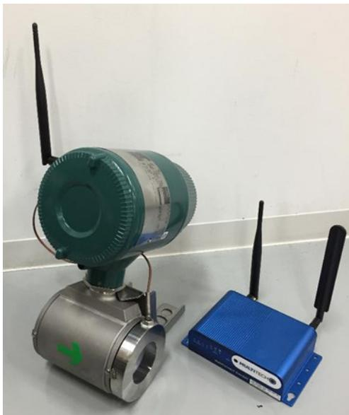
第2図 AI-IoT 温泉モニタリングシステム
