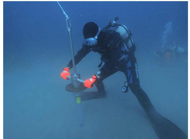
第4図 水中での堆積物コアの採取の様子。手動の打ち込み機を用いて、直径6 cmのパイプを打ち込み、表層の堆積物1 m程度を採取した。
