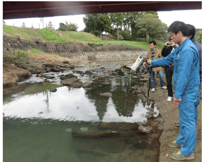
第5図 レーザー検知器を使ったメタンガス濃度測定を試み(2012年度特別見学会(地質編)) 測定しているのは、サポーターとして参加された村本良幸氏。
