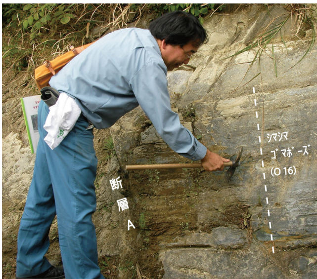
第31図 表通りからいすみ市文化とスポーツの森に入る分岐点付近でみられる断層 A と断層 A の上盤側 (右側) にみられるシマシマゴマボーズ (O16) 説明しているのは、世話人・案内人として参加された岩本広志氏。断層 A の下盤側 (左側) には、幅 1 m 以内の破砕帯が観察されます。(2009 年度特別見学会 (地質編))
