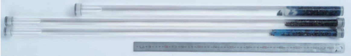
図1 タービダイトステッキの全体像。エンドキャップの採用により試料の交換が可能です。
