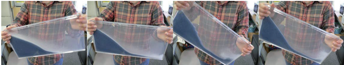
重力流発生実験の例。水中重力流の流動過程が手軽に再現できます。
