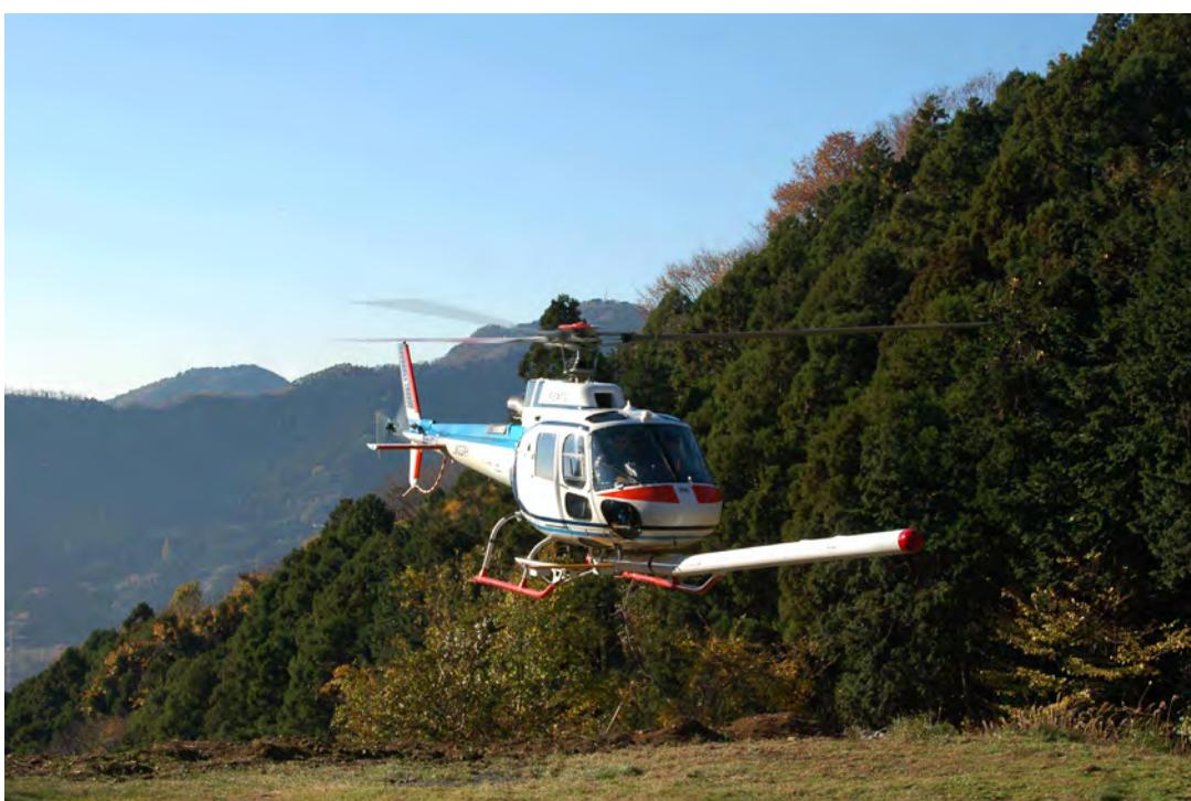
写真2 空中磁気探査ヘリコプター（中日本航空（株）所有）（大熊ほか, 2015）AS350B3型機。機体下部にスティンガーを固定し、その内部にCs磁力計センサーおよびプリアンプ、フラックゲート型磁力計センサーを収納する。撮影場所：神奈川県伊勢原市子易場外ヘリポート。
