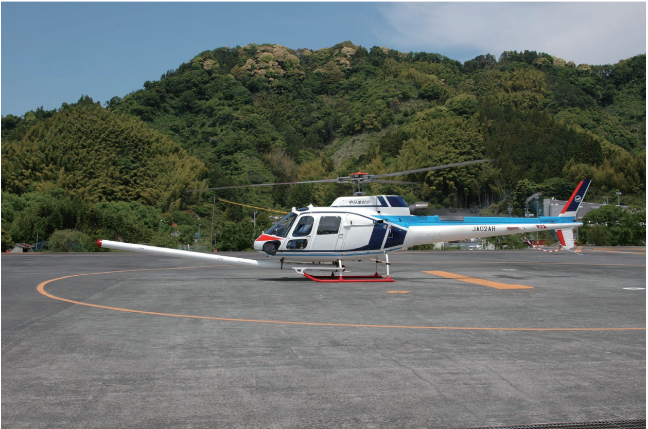
写真 1 空中磁気探査調査ヘリコプター（中日本航空（株）所有） AS350B3 型機。機体下部にスティンガーを固定し、その内部に Cs 磁力計センサーおよびプリアンプ、 フラックゲート型磁力計センサーを収納する。撮影場所：静岡県静岡市静岡ヘリポート。 Photo 1 Survey helicopter employed for the high-resolution aeromagnetic survey over the northern Suruga Bay area. Eurocopter AS350B3 owned by Nakanihon Air Service Co., Ltd. A Cs magnetometer sensor and its pre-amplifier, and a fluxgate sensor were installed in the stinger attached to the helicopter. The photo was taken at the Shizuoka Heliport, Shizuoka.
