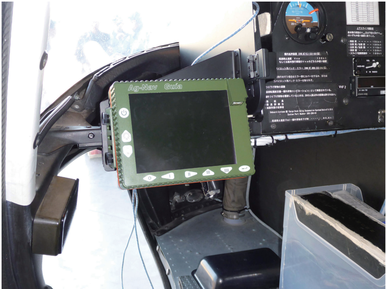
写真2 機上ナビゲーション装置 本体 (AGNAV 社 LiNav). Waypoint の入力や航跡の表示などを行い, 調査飛行中はナビゲータが操作する.
