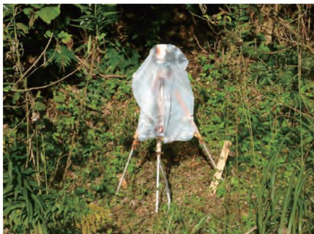
第6図 プロトン磁力計センサー。
