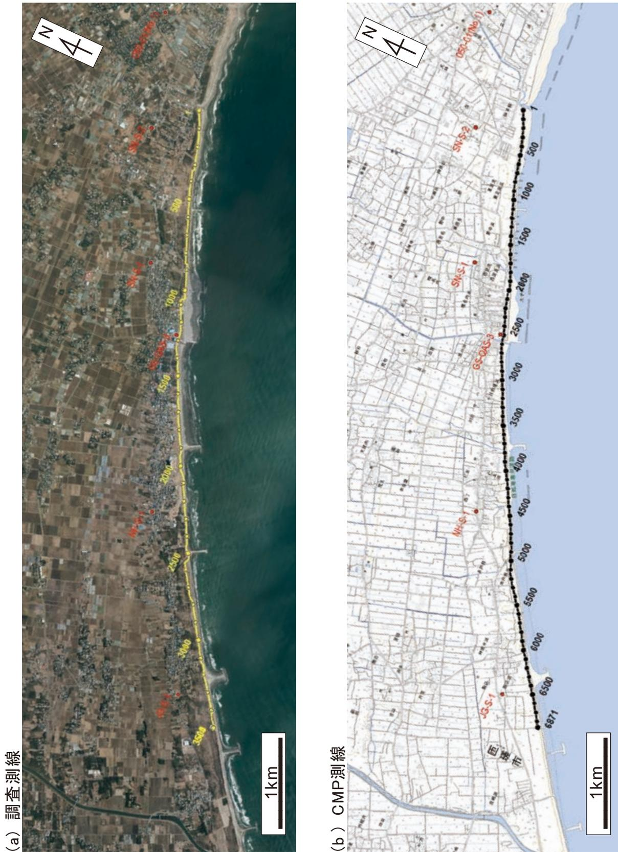
第2図 測線図. (a) 調査測線 数値は測点番号 (2 m 間隔), (b) CMP 測線 数値はCMP 番号 (1 m 間隔). 基図として国土地理院の地理院地図を使用した. 赤丸は沖積層基底に達した坑井 (小松原・水野 (2016) による).
