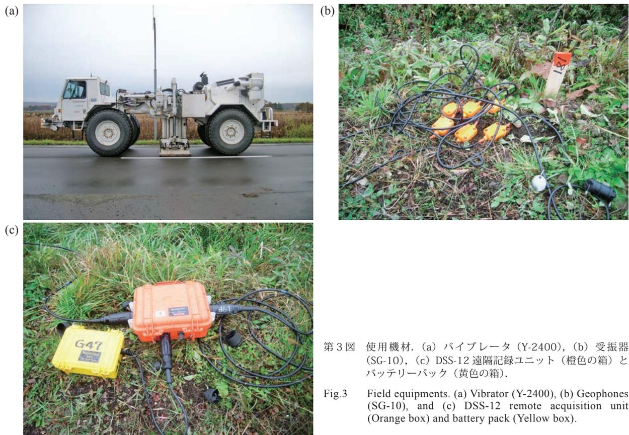
第 3 図 使用機材. (a) バイブレータ (Y-2400), (b) 受振器 (SG-10), (c) DSS-12 遠隔記録ユニット (橙色の箱) とバッテリーパック (黄色の箱).
