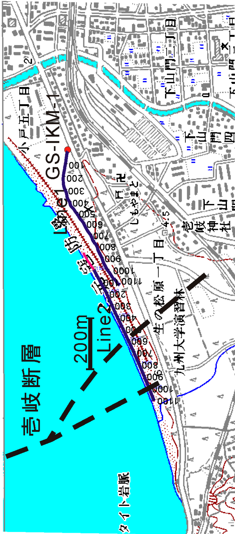
第 A-1 図 測線図。 測線の数字は発震点・受振点番号、ボーリングの位置も示した。赤い線は表面波探査で延長して調査した部分。 基図として数値地図 25000 (地図画像)「福岡」を使用。志岐断層の位置を加筆。
