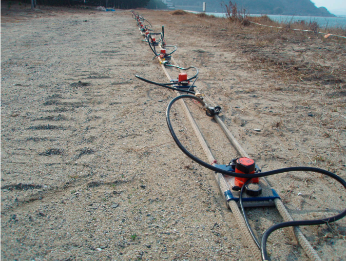
第 A-2 図 P 波震源・受振器 (ランドストリーマ).
