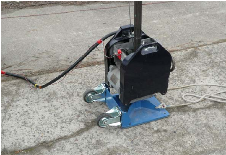
第5図 P波探査用ランドストリーマーおよび震源。(a) P波ランドストリーマー (LS_100P2), (b) P波ランドストリーマー (LS_100P3), (c) P波震源 (Drop Hitter)。
