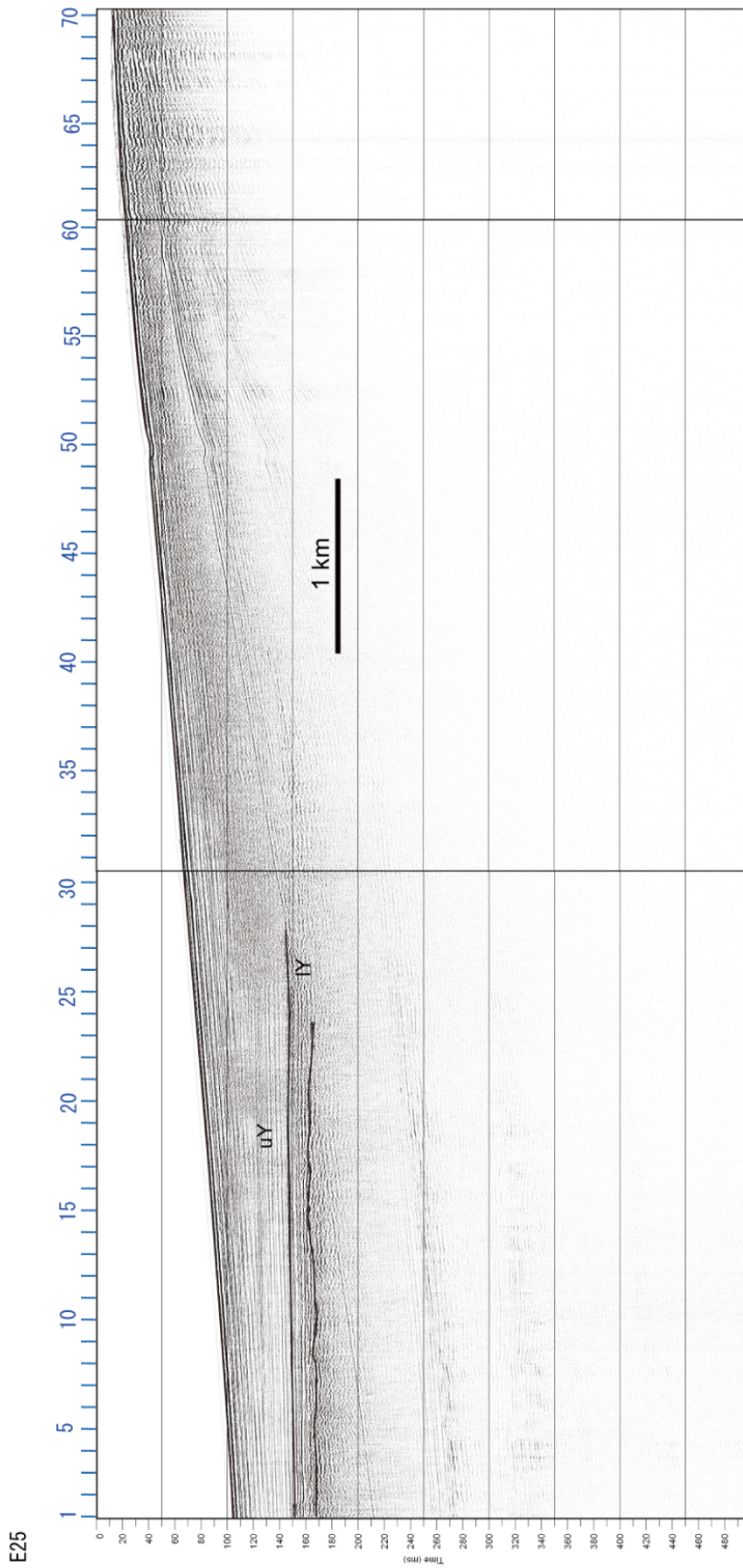
第 9 図 新潟沖 (E25) の反射断面。四ツ郷屋沖層下部層は明瞭な反射面を持つが、上部層中の反射面は明瞭ではない。水深 60 m 以深では四ツ郷屋沖層の基底面はほぼ水平に見えるが、沿岸部には音波散乱層が発達するため、海底下の構造が観察できない。IY: 四ツ郷屋沖層下部層, uY: 四ツ郷屋沖層上部層。
